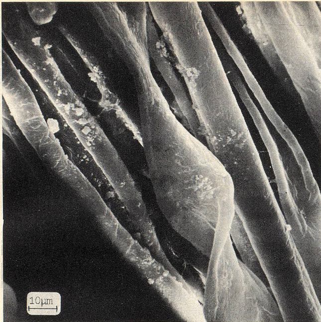
REM-Aufnahme (Rasterelektronenmikroskop-Aufnahme) von einem Baumwollgewebe nach fünfzig Wäschen mit phosphathaltigem Waschmittel. Dank richtiger Dosierung des Waschmittels bildeten sich keine Rückstände auf den Fasern
