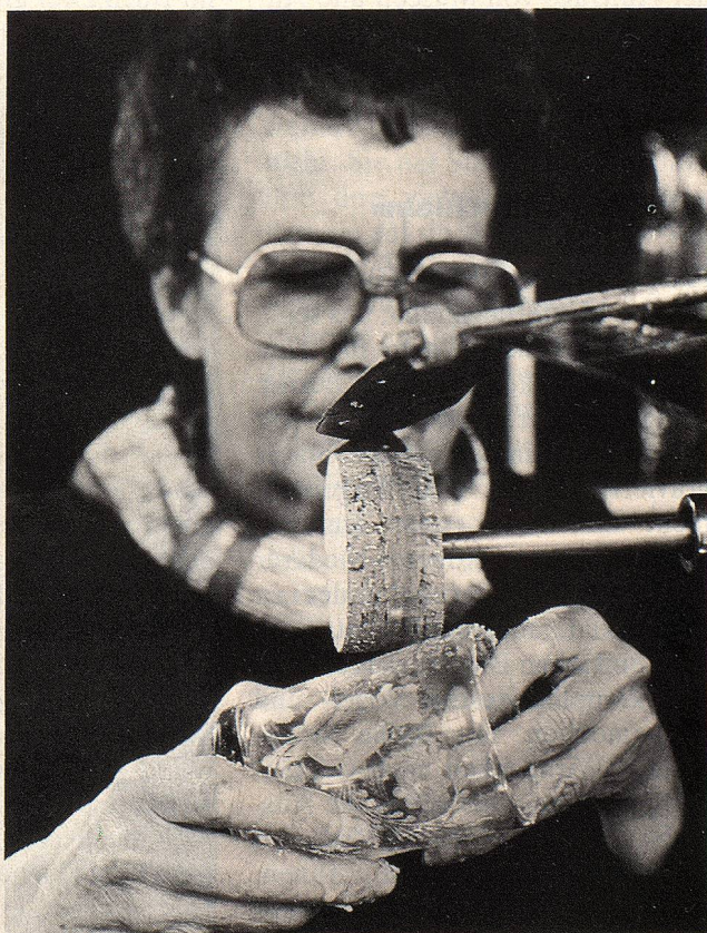
Mit Kork- und Bleirädern wird die fertige Gravur aufgehellt oder poliert
