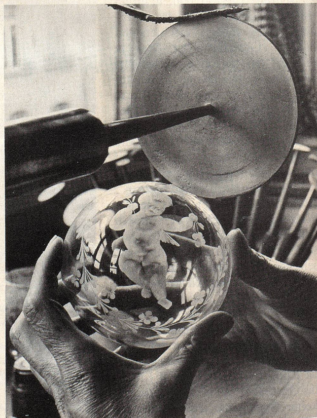
Das Kupferrad wird zum Schleifen mit Schleifmasse bestrichen. Die Künstlerin sieht oft kaum, was sie macht, weil das Glas ganz verschmiert ist
