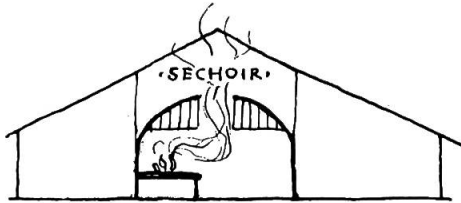
Fig. 2b. Feu ouvert et pare-étincelles : voûte de tuf, en berceau, avec ouverture vers le séchoir, «vôte». – Jura bernois.
