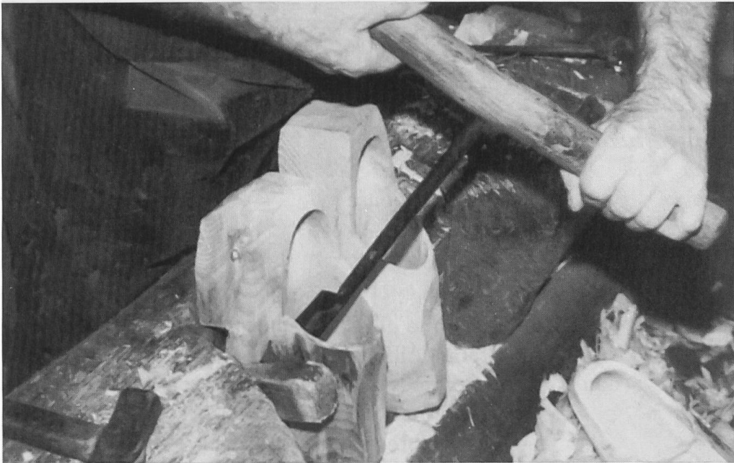
Creusage des sabots au moyen de la «cuillère» (photo Concours Cerlogne 1982 – Ecole moyenne de Brusson)
