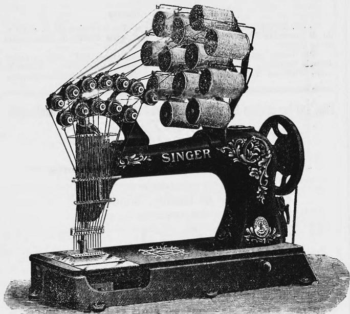
La Compagnie fabrique une variété de machines de 3 à 12 aiguilles avec navettes correspondantes dont les écartements sont établis sur commande. Ces machines conviennent particulièrement pour les travaux dans lesquels deux ou plusieurs piqûres parallèles sont nécessaires. On les emploie dans la confection du corset, de la robe, de la chaussure, etc.
