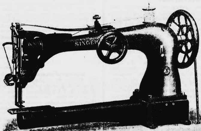
Cette machine avec son bras cylindrique d'une longueur de 53 cm est extrêmement pratique pour la confection des articles de forme tubulaire, tels que: bottes longues, portemanteaux en cuir ou en toile, sacs à charbon, pantalon de toile ou de cuir, etc. La grande distance entre l'aiguille et la base du bras permet aussi de passer les travaux volumineux de literie.
