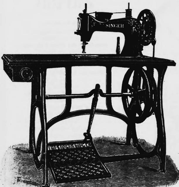
Cette machine est spécialement adaptée pour les travaux épais exigeant une grande force; sa longueur est de 52 cm, laissant un espace de 25 cm entre le bras et l'aiguille; elle donne un point de 10 mm et coud une épaisseur de 12 mm.
