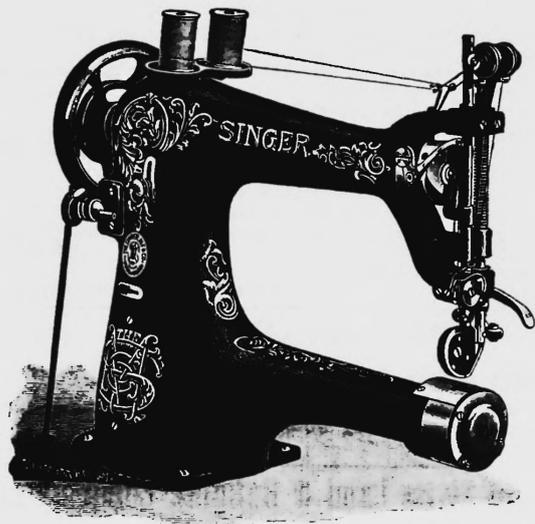
La machine classe 18 est montée avec un bras cylindrique de 6¼ cm de diamètre, dans lequel se trouvent deux navettes à mouvement oscillant, agissant conjointement avec deux aiguilles pour fournir deux piqûres parallèles parfaitement indépendantes l'une de l'autre.
