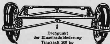
Drehpunkt der Einzelradabfederung
