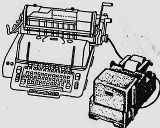
Der Adjutant wird auf die Testatur der Additionsmaschine aufgesetzt und durch ein Kabel mit der Schreibmaschine verbunden, deren Anschlag durch die elektrische Übertragung in keiner Weise geändert wird. Die Beträge können neben- oder untereinander geschrieben werden, die Verwendungsmöglichkeiten sind beinahe unbeschränkt:
