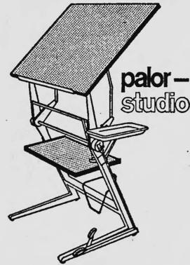
Beim palar-Studio ist das Zeichnungsbrett ohne Gegengewicht verstellbar. Der Gewichtsausgleich erfolgt durch zwei Federn. Der Raum zwischen den Füßen des Tisches bleibt dadurch zur Anbringung eines Abstellablares frei. Prospekt durch
