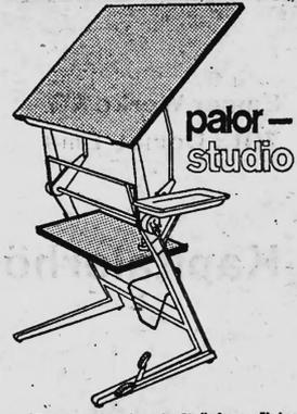
Das Zeichnungsbrett des palar-Studio kann mühelos in jede gewünschte Lage gebracht werden. Es lässt sich durch eine Klemmvorrichtung in verschiedener Höhe horizontal und in jeder Schräglage fixieren. Schwere Zeichnungsbretter bleiben durch die Wirkung von Federkraft auch bei geladeter Klemmvorrichtung im Gleichgewicht. Prospekt durch
