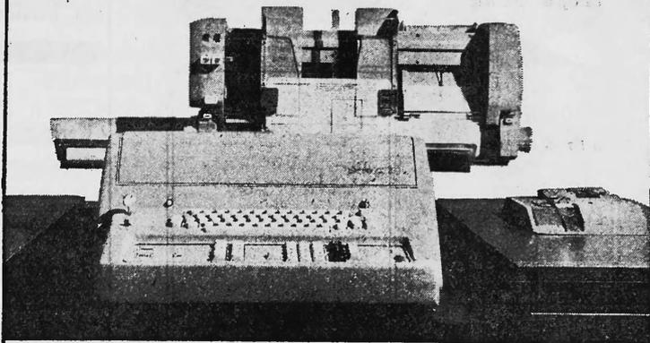
HERMES C-3, Buchungsautomaten nach Mass, können von 3 bis zu 11 Rechenwerken ausgebaut werden. Sie sind mit Volltext und, sofern erwünscht, mit Kurztext-Tastatur ausgerüstet. Aussergewöhnliche Vielseitigkeit durch Steuerschienen mit 4 und Tabulatorschiene mit 8 Programmen. — Besonders praktisch und wirtschaftlich ist die HERMES C-3 mit Monomatic- oder Bimatic-Einzugsautomaten. Mit angeschlossenem Streifen- oder Kartenlocher steht die HERMES C-3 im Dienste der Datenverarbeitung.
