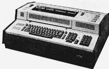
Die **-KLEINT-F93** ist eine Fakturiermaschine mit elektronischem Rechenwerk und der bewährten IBM-Kugelschreibmaschine. Durch neue Schaltungsprinzipien, verbunden mit einer Mehrfachausnutzung elektronischer Baugruppen, wurde eine kompakte tragbare Fakturiermaschine geschaffen, deren Leistung und Programmierungsmöglichkeiten bisher nur Fakturiermaschinen von Schreibtischgrösse und mit wesentlich höherem Preis vorbehalten waren.
