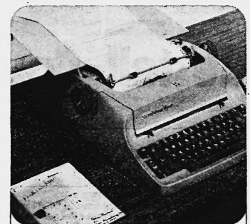
Der maschinenlesbare Schreibauftrag ruft die gewünschten Texte vom Magnetbandspeicher ab. Blitzschnell, mit über 1.2 Millionen Zeichen/min erfolgt die Selektionssteuerung.
