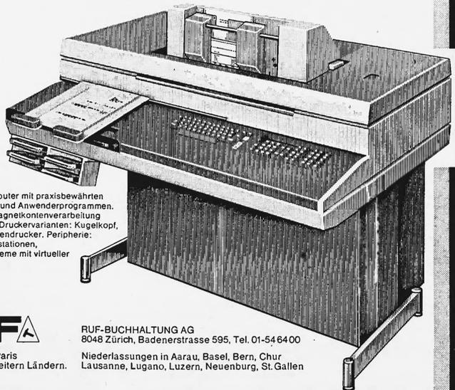
RUF-Practor-Computer mit praxisbewährten Betriebssystemen und Anwenderprogrammen. 2 bis 64 K-Byte. Magnetknotenverarbeitung bis 1024 St/Seite. Druckvarianten: Kugelkopf, Nadeldrucker, Zeilendrucker. Peripherie: 1/4"-Magnetbandstationen, Magnetplattensysteme mit virtueller Adressierung.
