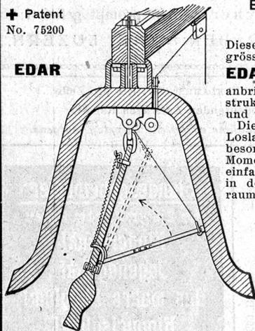
Diese Sperrvorrichtung Edar ist von grösster Einfachheit, leicht bedienlich und lässt sich an jeder bis grössten Glocke bequem anbringen. Ihre Einfachheit in Konstruktion bürgt für grosse Solidität und vermeidet Störungen.
