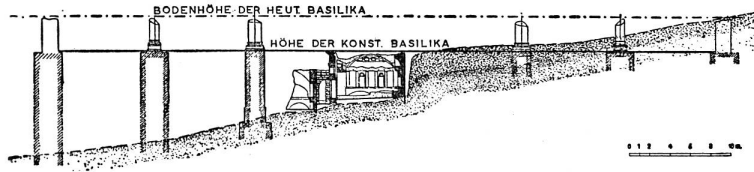
Abb. 2: Querschnitt (Süd-Nord) durch die konstantinische Basilika und die darunter liegende Nekropole.
