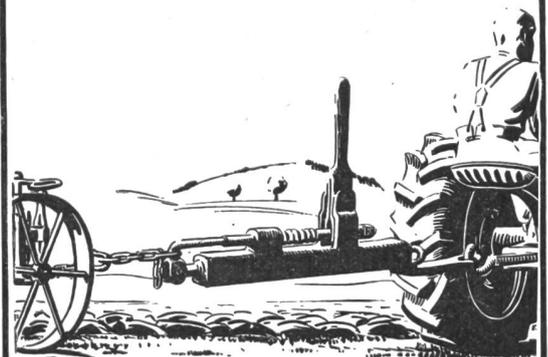
**Automatischer Ausklinke-Apparat für Traktorflug**
