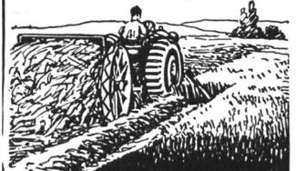
Graszettmaschine mit konzentrischer Haspel-Lagerung auf Radachse u. regulierbarer Wurfweite. — Patentiert.
