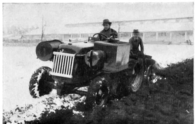
Bühler-Traktor mit Holzkohlengas-Antrieb
