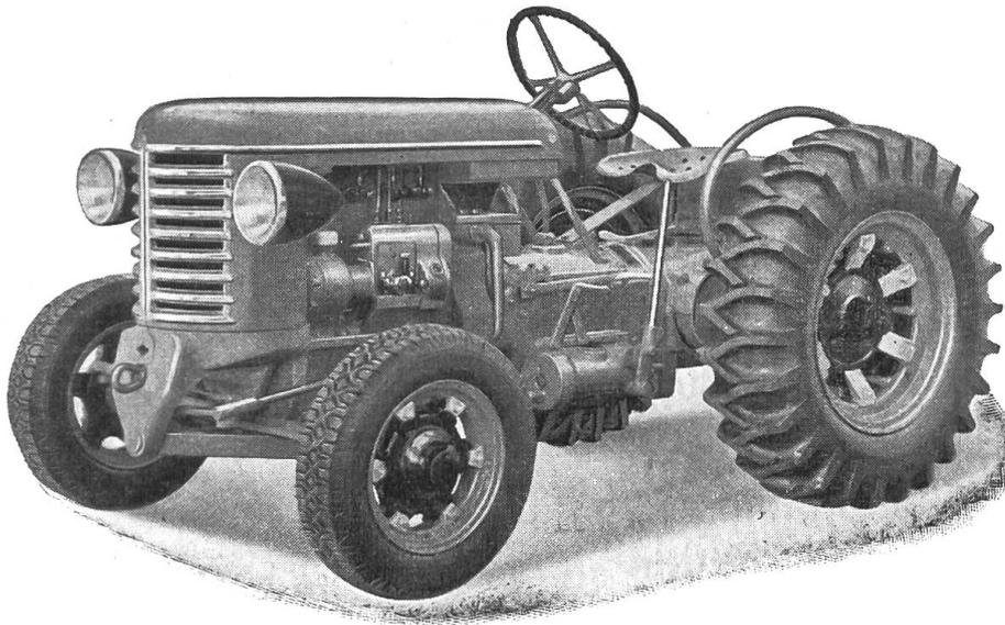
Zentrale Zapfwelle - 7- oder 8-Gang-Getriebe und
