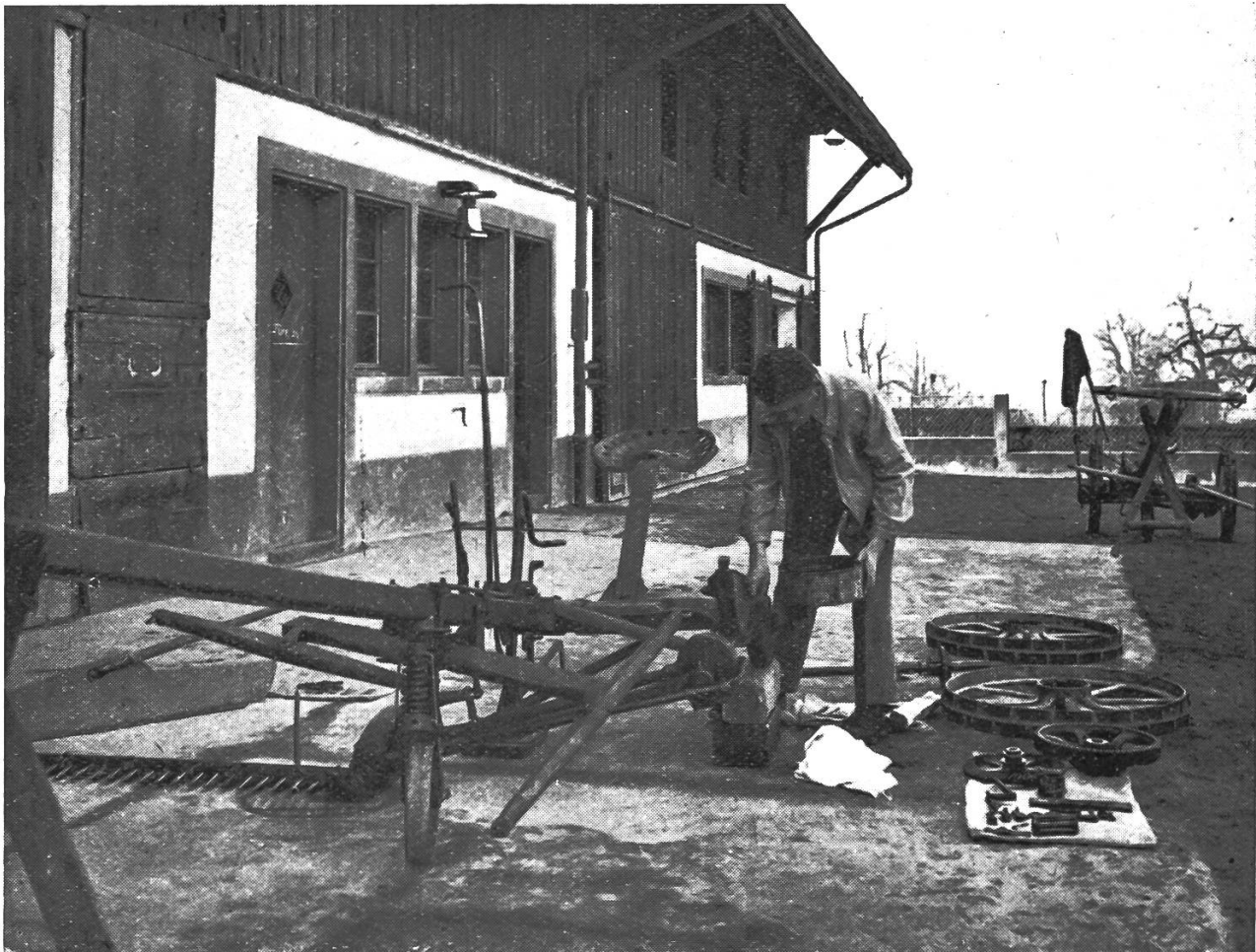
Abb. 1: Gründliche Revision und Reinigung einer Mähmaschine
