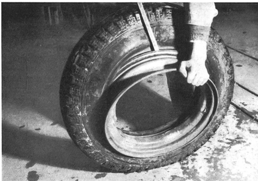
Abb. 6. Entfernen des Pneus von der Felge.
