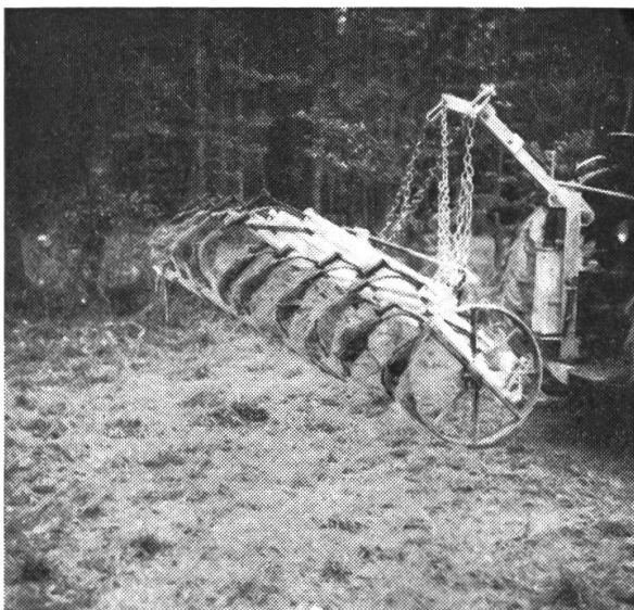
Abb. 7: Angehängter Kultivator mit hydraulischer Hebevorrichtung (hochziehbar).
