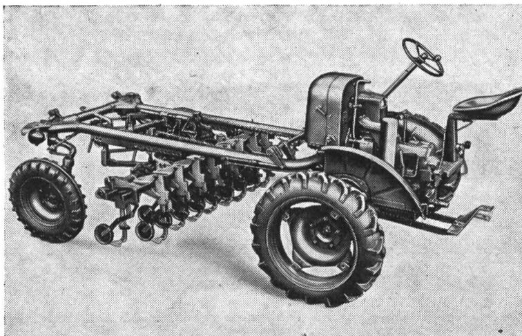
Einige technische Daten des Lanz-Motor-Geräteträgers: 12 PS-Motor; 5 Vorwärtsgänge, 1 Rückwärtsgang; mögliche Geschwindigkeiten von 2,57 bis 19,0 km/h.; 2 Zapfwellen, getrennt schaltbar, 540 Umdr./min.;
