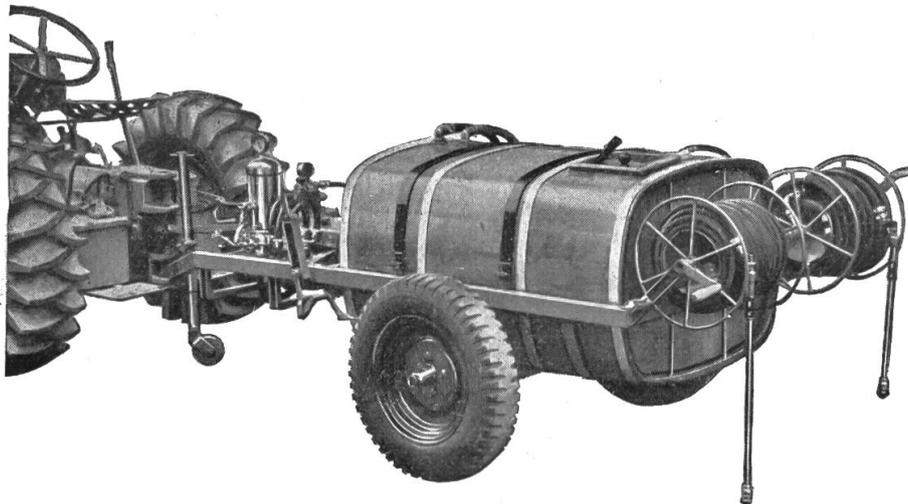
Motorpumpe angetrieben durch Traktor mittels Cardanwelle
