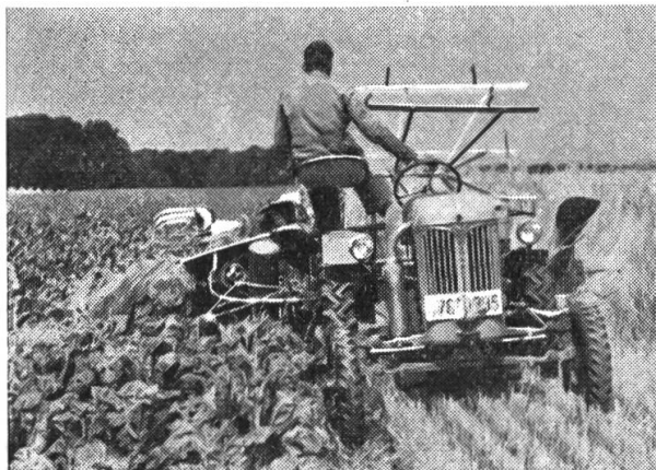
Abb. 3: Frontbinder beim direkten Anmähen nach Verfahren 1.
