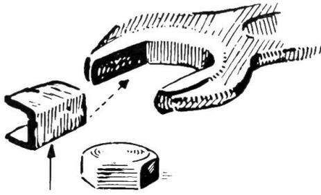
Nötigenfalls kann ein Schlüssel durch einen eingelegten Blechwinkel einem Schraubenkopf (Mutter) kleinerer Schlüsselweite angepasst werden.
