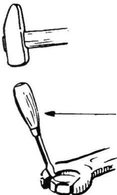
Ein zwischen Kopf und Schlüssel gekelter Schraubenzieher dagegen beschädigt beide Teile.
