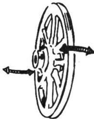
Durch Wackelbewegung das radiale Spiel feststellen und durch Einziehen einer neuen Büchse oder Aufschieben einer Blechhülse
