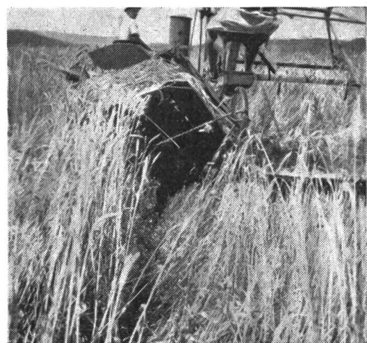
Abb. 2. Das Arbeitsergebnis des Halmabteilers von hinten gesehen.
