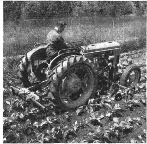
Links: Hackarbeit mit rückwärtigem Gerät, durch Hilfsperson gesteuert.
