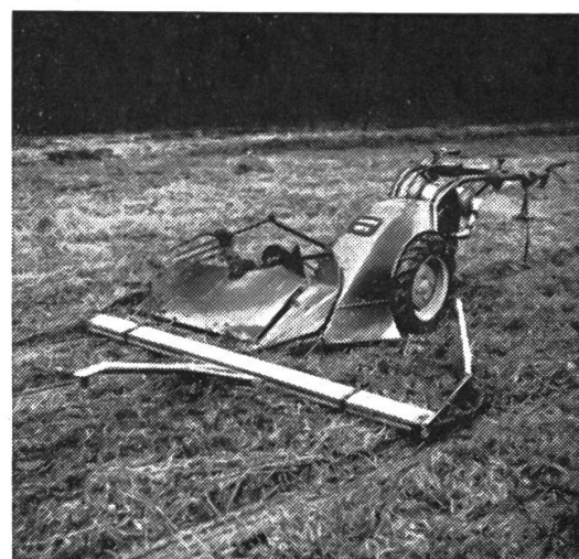
Abb. 3: Motormäher mit am Mähbalken eingehängter Deichsel.
