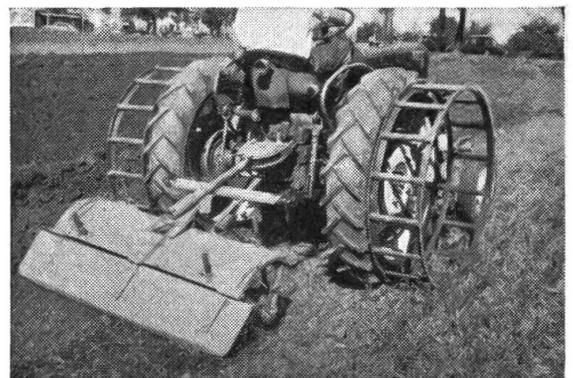
17 Traktor Lanz mit Gitterrädern beim Kultivieren. Bei dieser schweren Arbeit sind Gitterräder sehr wertvoll, denn sie erhöhen die Zugkraft des Traktors durch Verbesserung der Adhäsion um 30—40 % und helfen mit, den Boden zu zerkleinern.
