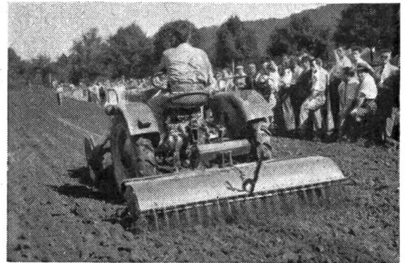
16 Traktor Steyr 80a mit Gitterrädern und zapfwellengetriebener, hinten angebauter Hako-Egge beim Bearbeiten eines Stoppelfeldes.
