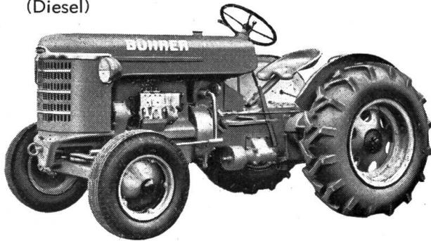
**Gewicht** ohne Zusatzgewichte: mit Stahlrädern 1750 kg; mit Gussrädern 1950 kg.
