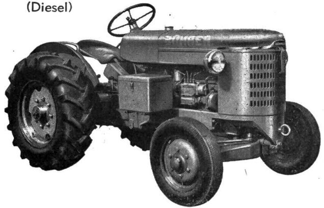
**Gewicht** ohne Zusatzgewichte: mit Stahlrädern 1600 kg; mit Gussrädern 1800 kg.
