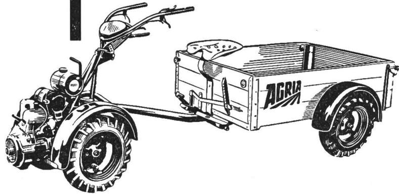
**AGRIA-Universal** 5 PS 200 cm<sup>3</sup> mit Anhänger als Transportfahrzeug, Nutzlast 400 kg, Geschwindigkeit 20 km/Std.
