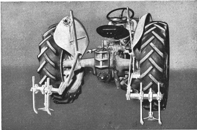
Die Verwendung von Spurlockern ist beim Ueberfahren des gepflügten Ackers mit Traktoren und gezogenen oder angebaute Eggen, Sämaschinen, Walzen, usw. unerlässlich. Bis vor kurzem wurden die Spurlockerer in der Regel mit einem Verlängerungsstab an der Ackerschiene des
