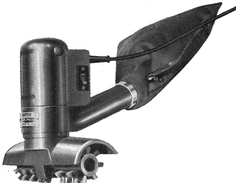
900 U/min. Motor 24 V, 130 W. Gewicht des Apparates ohne Kabel 2,5 kg.
