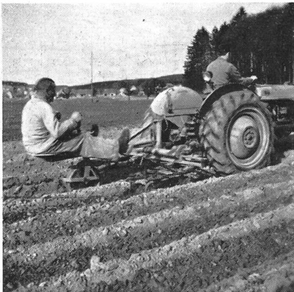
Das Vielfachgerät «Kombi» beim Hacken ohne Steuervorrichtung.
