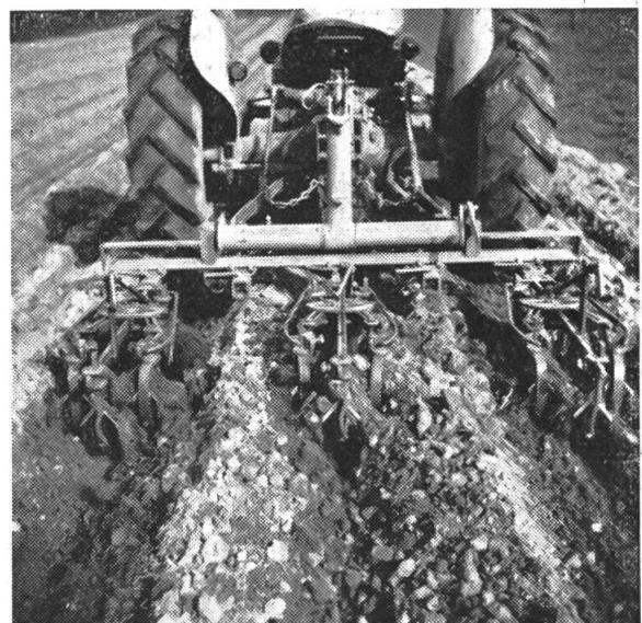
Das Vielfachgerät «Kombi» beim Hacken mit Steuervorrichtung.
