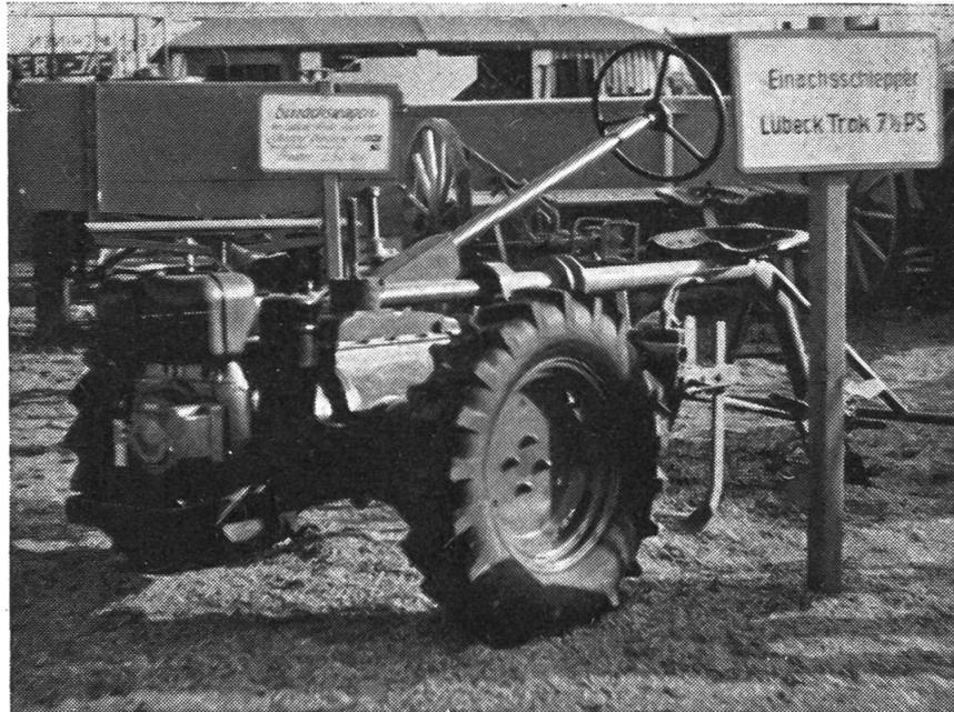
Abb. 16: Der neue Lubeck-Trak, 7,5 PS. Er wird im Gegensatz zu andern Einachsern vom Fahrsitz aus mit Handrad gesteuert.
