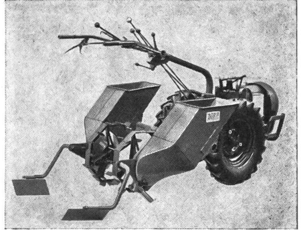
Abb. 17: Monax-Geräteträger mit angebauter Mähmaschine für Zapfwellenantrieb.
