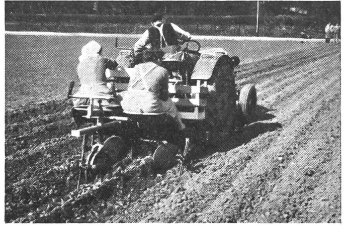
Abb. 15 Bucher-Sämaschine an der Dreipunktaufhängung des «Meili». Rechts von der Sämaschine das Markiergerät, in dessen Furche das rechte Trakturvorderrad zurückfahren muss.
