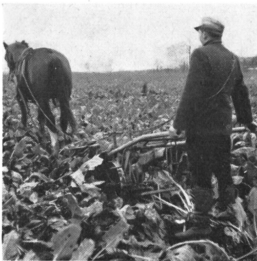
Abb. 1 Mech. Schippen, 2reihig (1-Mannsystem)
