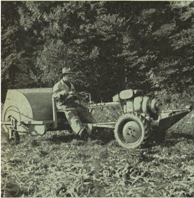
Abb. 2c: Zetten in gesondertem Arbeitsgang, mit einem Einachstraktor als Zugmaschine. (Das Zetten wird durch das Wendemanöver erschwert.)
