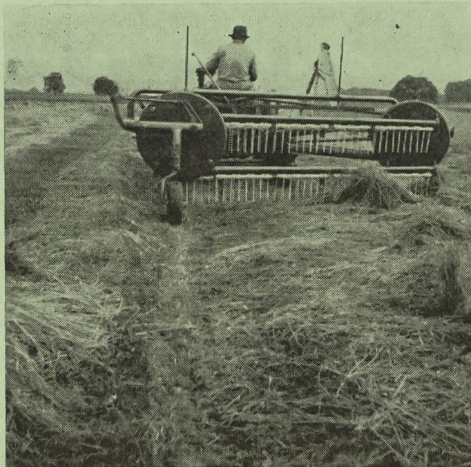
Abb. 4c: Kombiniertes Schrägtrommel-Schwadenrechen für Zapfwellenantrieb mit aufklappbaren Zinkenfeldern.
