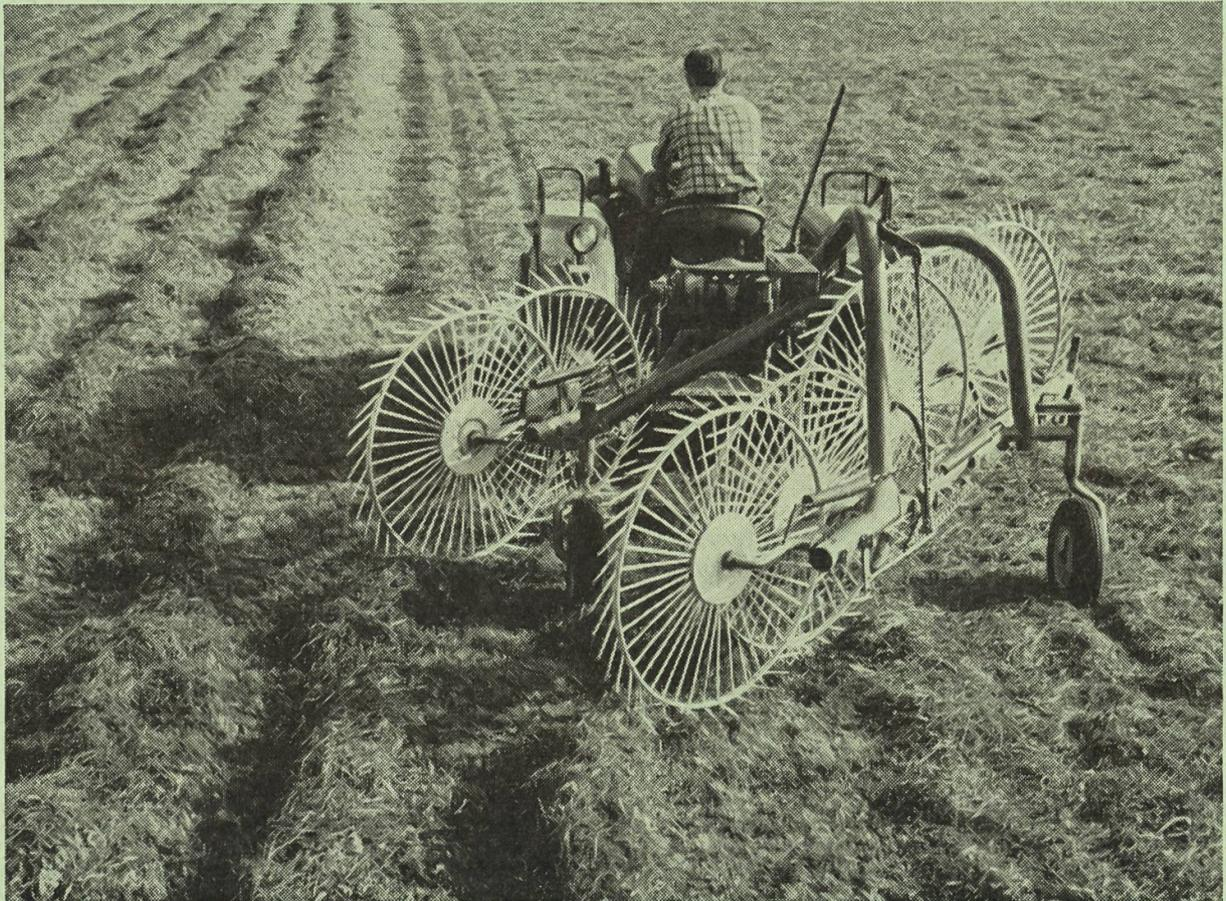
Abb. 5c: Anordnung der Sternräder in zwei Gruppen zur Herstellung von zwei Kleinschwaden (evtl. späteres Wenden derselben).
