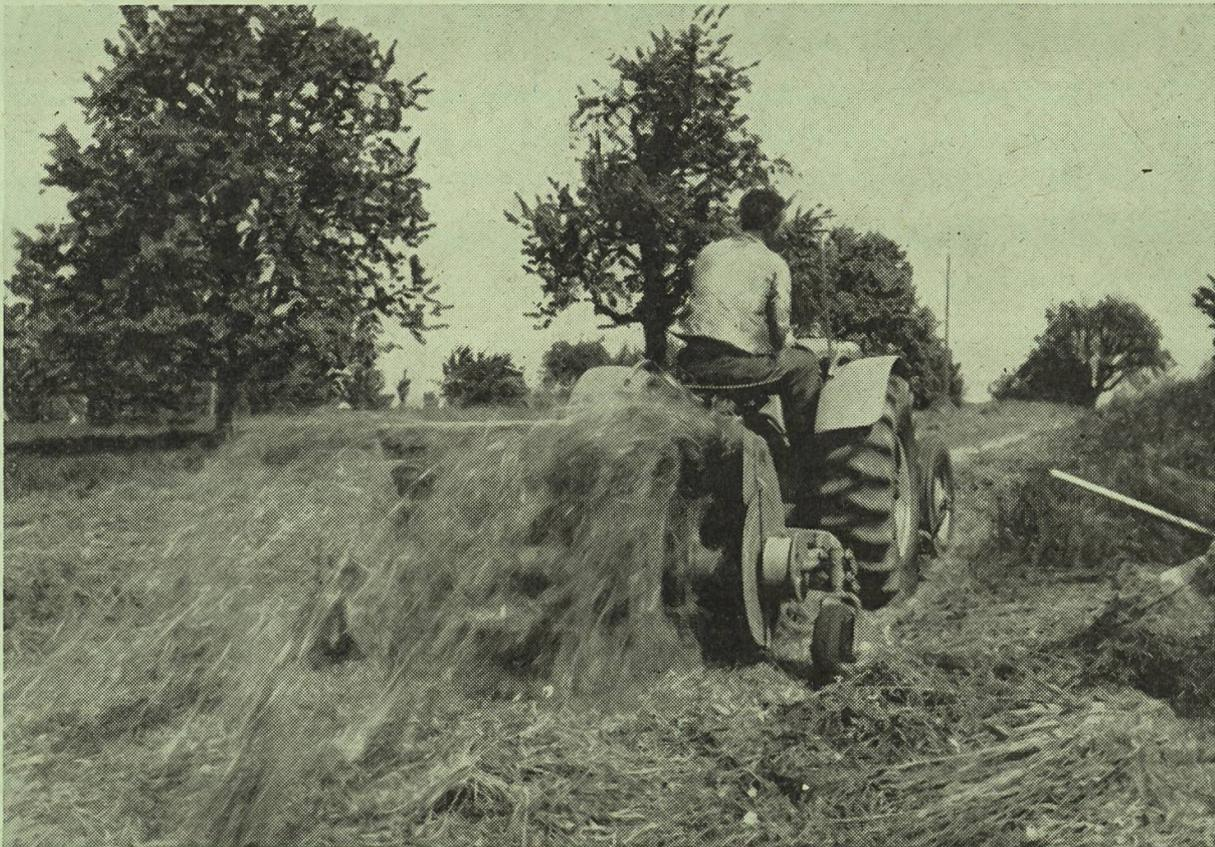
Abb. 2a: Mähen und Zetten im gleichen Arbeitsgang.
