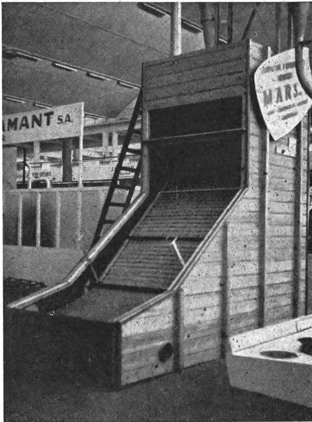
Der neue Getreidetrockner Mars ist sehr einfach im Aufbau. Er leistet 1—1,5 t/std.
