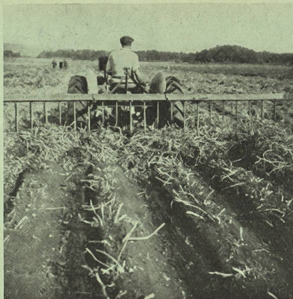
Abb. 5: Krautreden als Anbaugerät für Traktoren. (Man beachte die Anpassung der Zinkenlänge an die Kammkultur.)
