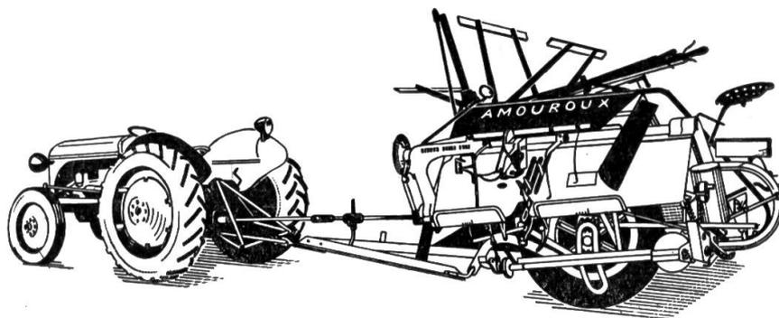
Die grossen Vorteile der **«AMOUROUX» - Bindemäher** haben sich durchgesetzt. Boden- und Zapfwellenantrieb in einer Maschine (umschaltbar). Die flexible Zapfwelle bis zu 90 Grad abschwenkbar.
