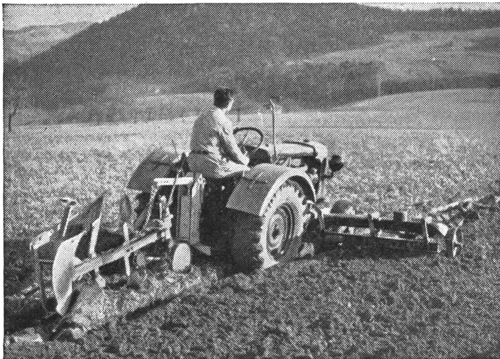
**Ott-Anbaupflüge** mit Stützrädern leisten in der Ebene und am Hang beste Arbeit. Sie sind während der Arbeit weitgehend unabhängig von den Bewegungen des Traktors und in der Arbeitsleistung deshalb den Selbsthalterpflügen am ähnlichsten. Verlangen Sie unverbindliche Offerten für Anbaupflüge und Anbaukultivatoren.
