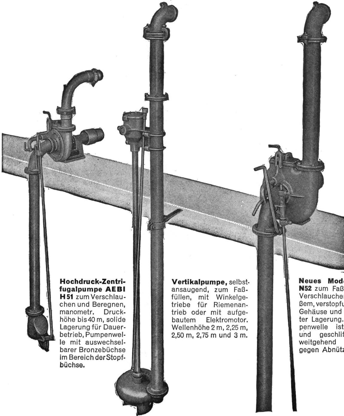
**Hochdruck-Zentrifugalpumpe AEBI H51** zum Verschlauchen und Beregnen, manometr. Druckhöhe bis 40 m, solide Lagerung für Dauerbetrieb, Pumpenwelle mit auswechselbarer Bronzebüchse im Bereich der Stopfbüchse.
