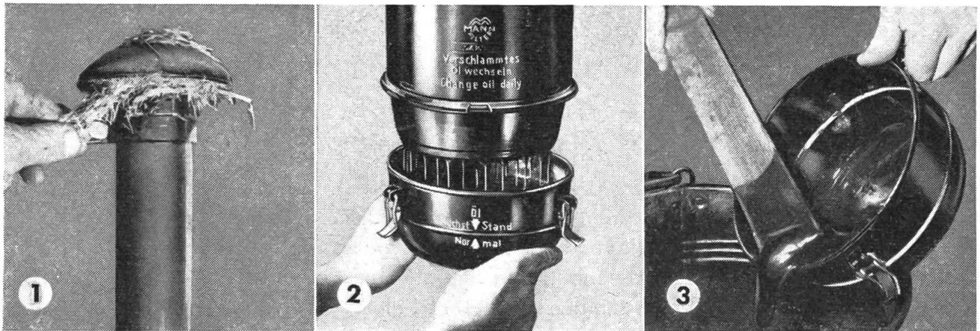
1) Ansaugrohr nachsehen      2) Oeltopf regelmässig abnehmen      3) Oelfüllung wechseln
