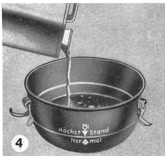
4) Motorenöl nur bis untere Normalstand-Marke einfüllen
