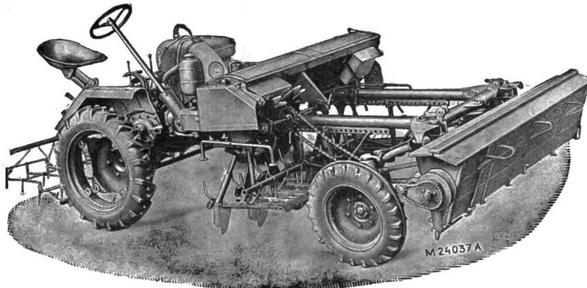
Mit **Sämaschine**, 2 m Arbeitsbreite, mit 11 Scharen. Mit **Düngerstreuer**, 2 m Arbeitsbreite. Mit **Vielfachgerät** für Kartoffelkultur 3reihig: mit halbautomatischen Setzapparaten, mit Hackapparat für Rüben, Raps usw., 2 m Arbeitsbreite. Für 4 Reihen mit einteiligen Parallelogrammen.
