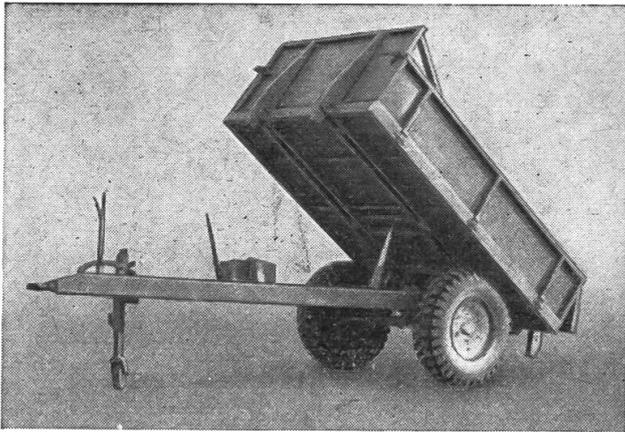
Universal-Anhänger als Kipper 1,5 m<sup>3</sup> Inhalt, mit abgelegter Front- und Rückwand als Heu- und Graswagen verwendbar.
