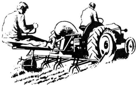
► Hochwertige, hangssichere Hackmaschine durch Feinsteuerung der einzelgefederten Hackwerkzeuge in der Ebene und am Hang. Eignet sich ausgezeichnet für alle Hackkulturen. Arbeitet mit oder ohne Steuermann.
