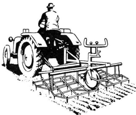
► Doppelwirkende Anbauegge, durch Steuerträger belastet und unbelastet arbeitend. Nutzbare Arbeitsbreite 2,20 m.
